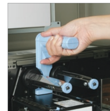
La tête se déplace verticalement pour un accès facile
